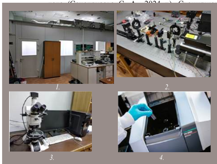
Рис. 4. 1 — Чистое помещение площадью 17 м 2 класса чистоты ISO7, 2 — Оптическая установка, 3 — Оптический поляризационный микроскоп, 4 — Двухлучевой спектрофотометр.
