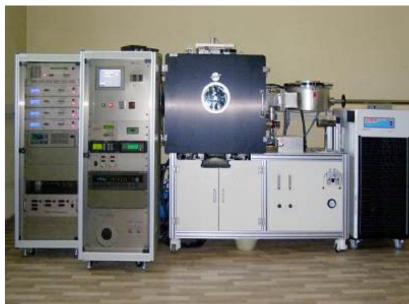
Рис. 1. Базовая вакуумная установка, предназначенная для разработки источников плазмы и напыления покрытий.
