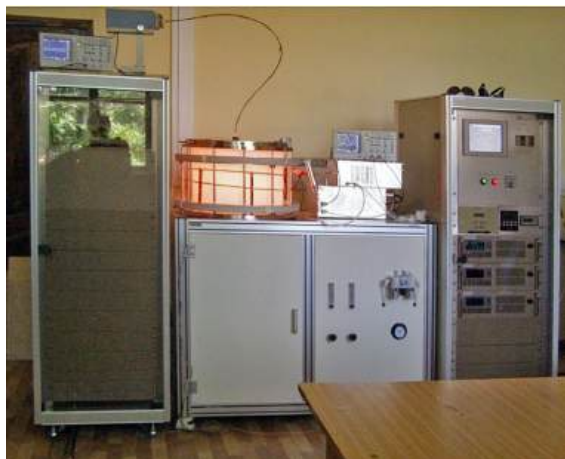
Рис. 2. Вакуумная установка для изучения свойств ВЧ разряда, помещенного во внешнее магнитное поле.
